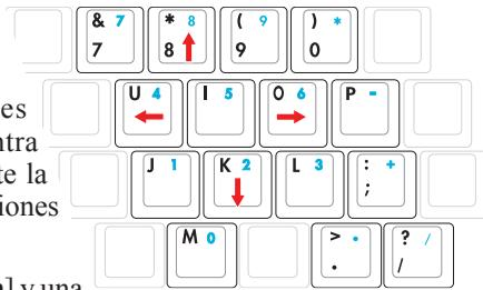
**Con el bloqueo numérico desactivado**, pulse la tecla **[Fn]** y una de las teclas de cursor indicadas a continuación. Por ejemplo **[Fn]** **[8]** para desplazarse hacia arriba, **[Fn]** **[K]** para desplazarse hacia abajo, **[Fn]** **[U]** para desplazarse a la izquierda y **[Fn]** **[O]** para desplazarse a la derecha.
