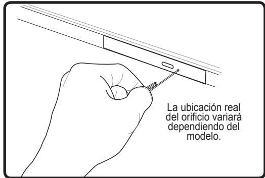
El mecanismo de expulsión de emergencia se encuentra ubicado en un orificio situado en la unidad óptica y se utiliza para expulsar la bandeja de la unidad óptica en caso de que la función de expulsión electrónica no funcione. No utilice el mecanismo de expulsión de emergencia en lugar de la función de expulsión electrónica.
