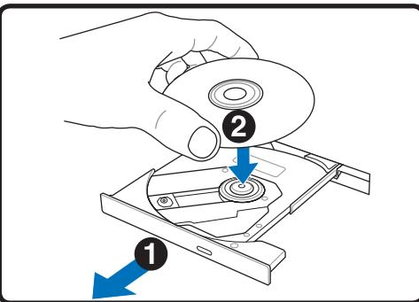
1. Con el PC Portátil encendido, pulse el botón de expulsión de la unidad para abrir parcialmente la bandeja de disco.
